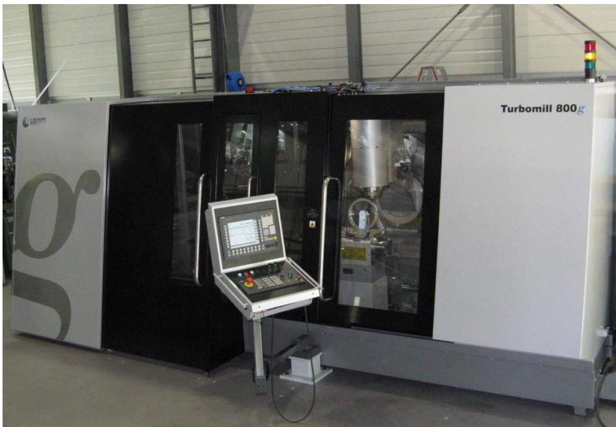
Die LIECHTI Turbomill 800g ist eine hochdynamische fünfachsige Fräsmaschine mit höchsten Achsbeschleunigungen, konzipiert für das Hochgeschwindigkeitsfräsen in 5 Achsen.
